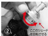
①ヘッドライトの形状に応じて最適な配光を調整する事ができます。
